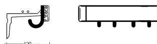
11.360.15 crochet: acier Ø 10 mm, avec finition synthétique noir (rilsanisation) Hauteur profilé: 60 mm
